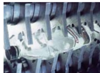
大小のグリッパーを持った特殊形状のローラーが各種サイズの容器を確実に取り込み処理します。
